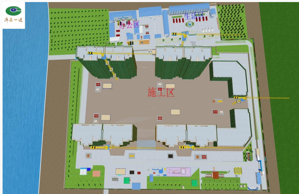
施工现场三区分离
